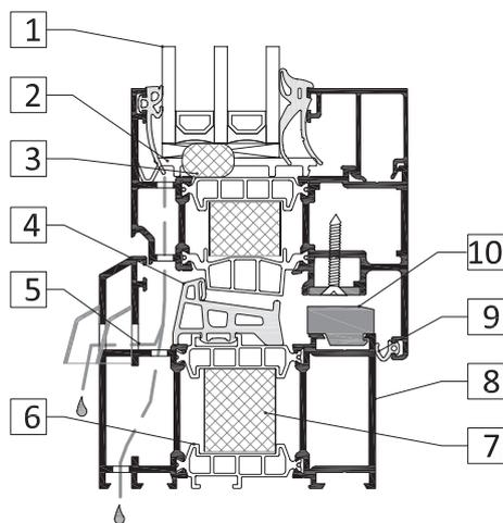
1. Glasdicken von 24 mm bis 50 mm in Flügel und Blendrahmen einsetzbar.
