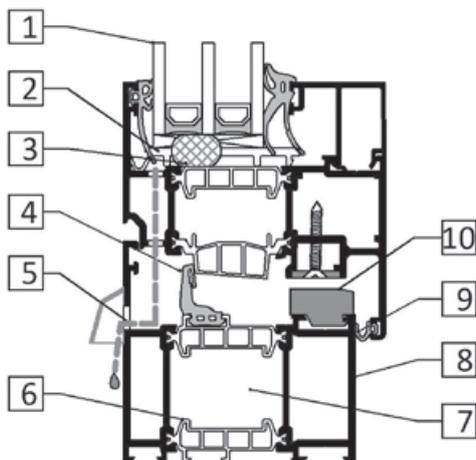
1. Glasdicken von 24 mm bis 50 mm in Flügel und Blendrahmen einsetzbar.
